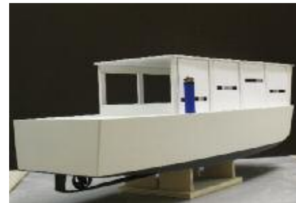
Flacher Rumpf, Sichtluken mit verstellbaren Sechsschlitzen. Ein Feuerzeug dient als Maßstab.
